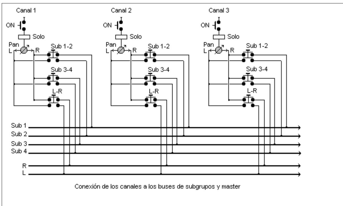
En la figura se muestran solo 3 canales. El resto de los canales de una mesa sigue el mismo esquema.
