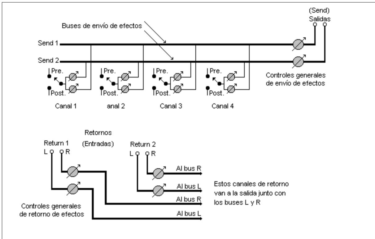
El mismo esquema vale para los envíos y retornos auxiliares, de monitor, etc. Un conjunto envío-retorno de efectos puede utilizarse con un sistema de monitoreo conectando la salida o envío a un sistema de amplificación cuyos parlantes estén en el escenario. El retorno, en este caso, no se utiliza. Lo mismo vale si en la mesa vemos que dice AUX u otra palabra similar.
